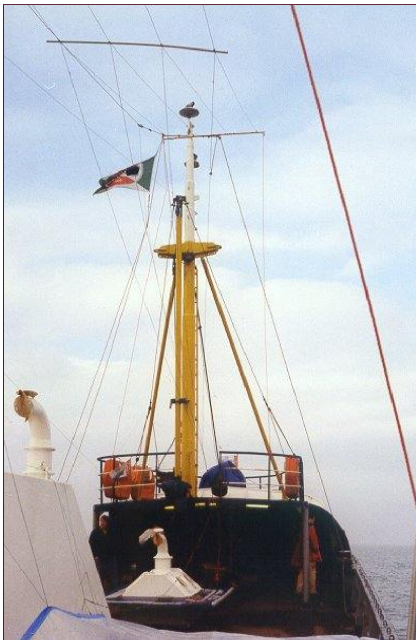
Ein Teil der Antennenkonstruktion auf dem Offshore-98-Sendes Schiff.
